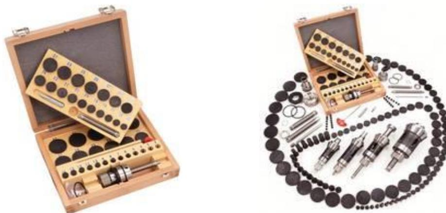
Sie erhalten das System als Universalset im zweckmässigen Holzkoffer mit sämtlichen, für jeden Spannzangendurchmesser korrekten, Anschlagtellern.
