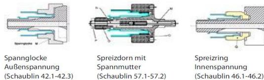
Spannglocke Außenspannung (Schaublin 42.1-42.3)
